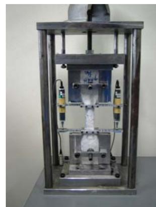
写真－2 引張試験装置<sup>4)</sup>
