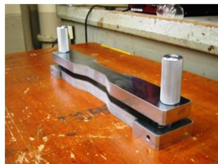
写真－1 ダンベル型供試体を切削加工するために用いるサンプルホルダー
