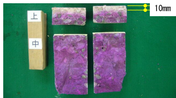
写真－2 中性化深さの試験結果（CASE3）
