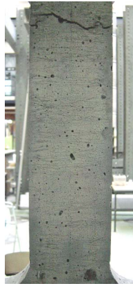
写真-3 UHP-SHCC のひび割れ性状(左: 全体, 右: 拡大)
