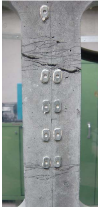
写真-2 N-SHCC のひび割れ性状
