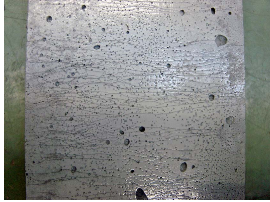
写真-3 UHP-SHCC のひび割れ性状(左: 全体, 右: 拡大)
