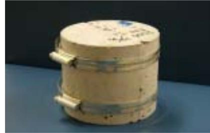
写真 - 1 供試体ひび割れ幅保持状況
