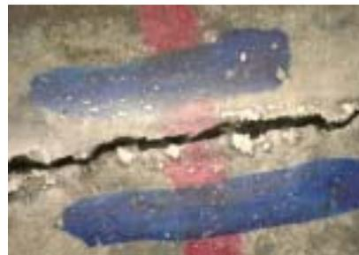
写真 - 7 配合 6 養生条件 A ひび割れ導入後
