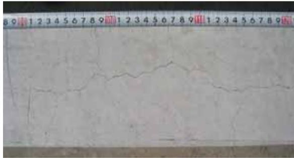
写真-2 上面のひび割れ発生状況 (H-A)
