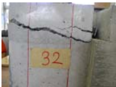
写真-1 破壊状況 (No.10)
