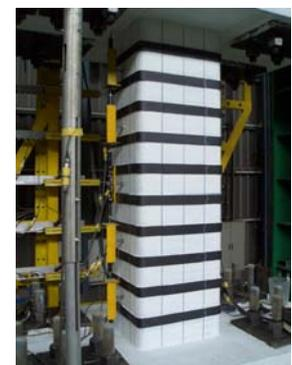
写真-1 L 型 CFRP 板
