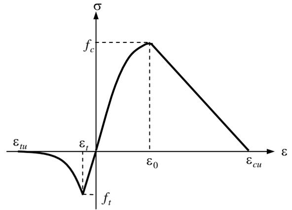
図 - 8 垂直バネの応力～ひずみ関係
