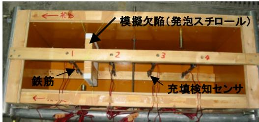
写真-2 打設前の試験体状況
