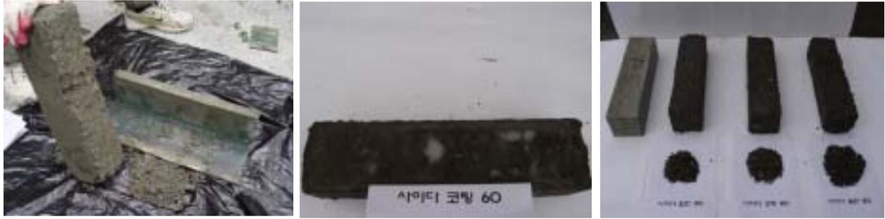
(a) 型枠の脱型 (b) 型枠脱型後の試験体 (c) コンクリートの未凝結残量
