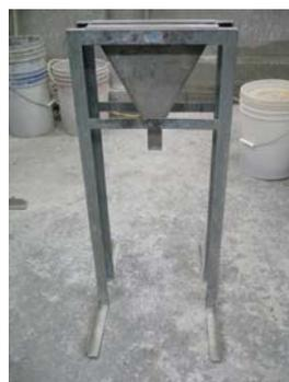
写真-2 V漏斗試験器
