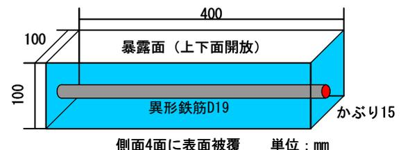
図-1 全体浸漬実験供試体の形状・寸法
