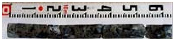
写真-2 実構造物の奥行方向直交ひび割れ
