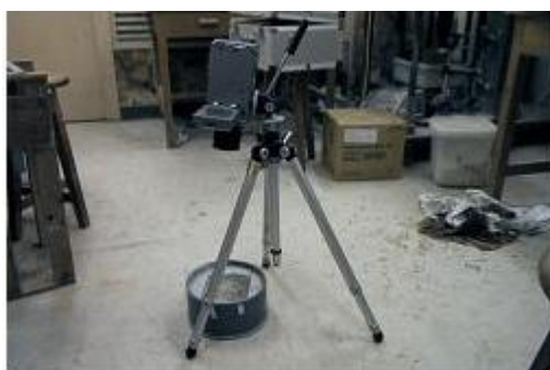
写真-4 サーモグラフ
