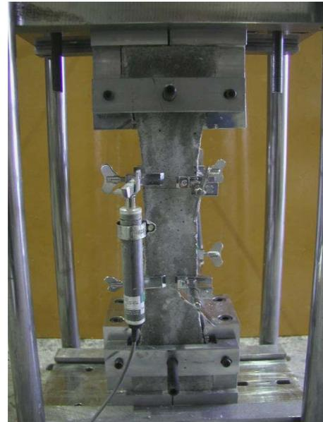
図-2 一軸引張試験
