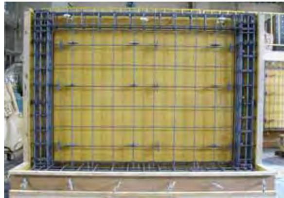
図 - 8 実大暴露試験体の概要
