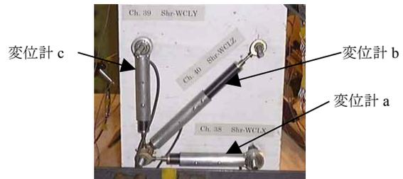
写真-1 ロゼット型に配置した変位計
