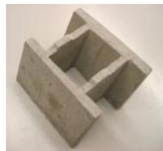
写真 - 1 大型ブロックの模型
