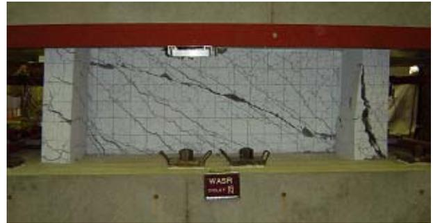
ASR コンクリート試験体
