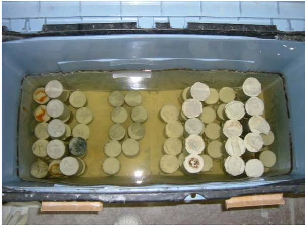
写真-2 希硫酸浸漬試験状況
