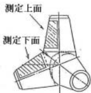
図-2 表面剥離部分測定面
