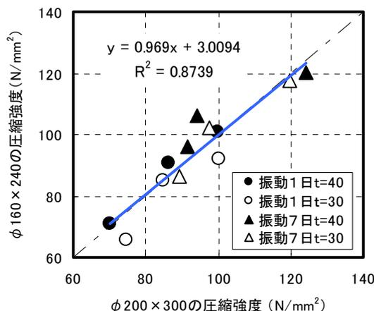
図-2 振動成形での圧縮強度の比較
