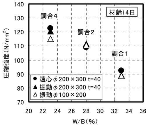
図-8 円筒形状と円柱形状の圧縮強度
