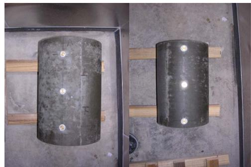
写真-2 乾燥収縮試験体
