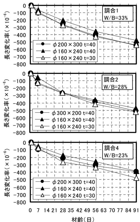
図-5 乾燥収縮の経時変化
