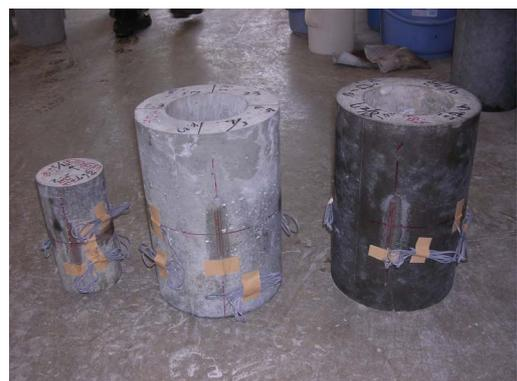
写真-3 円筒試験体と円柱試験体
