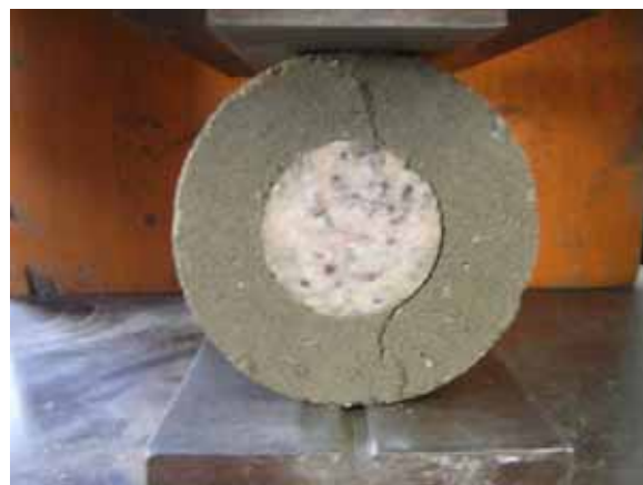
写真-1 モデル供試体の割裂引張破壊
