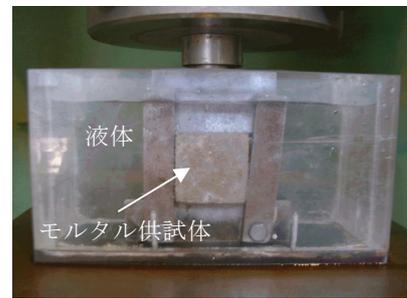
写真-1 圧縮試験状況
