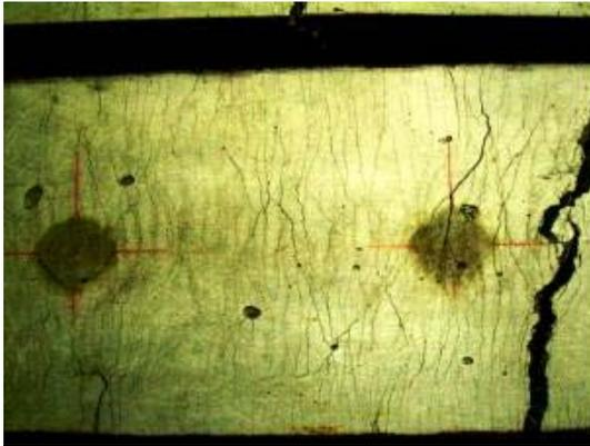
写真-1 複数ひび割れ発生状況
