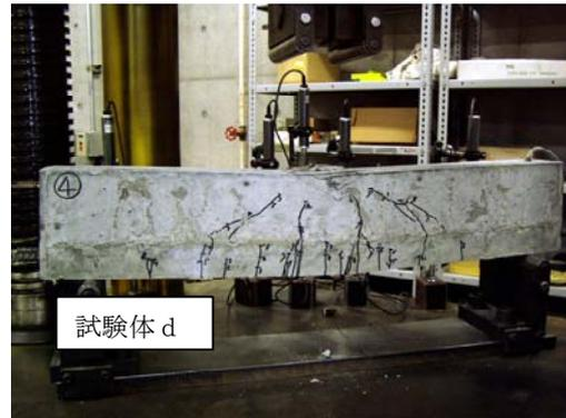
写真－２ ひび割れ発生状況の一例
