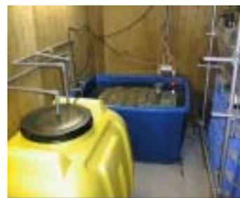
写真 - 1 塩水浸せき試験装置
