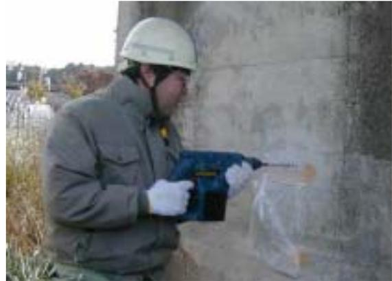
写真 - 2 試料の採取状況
