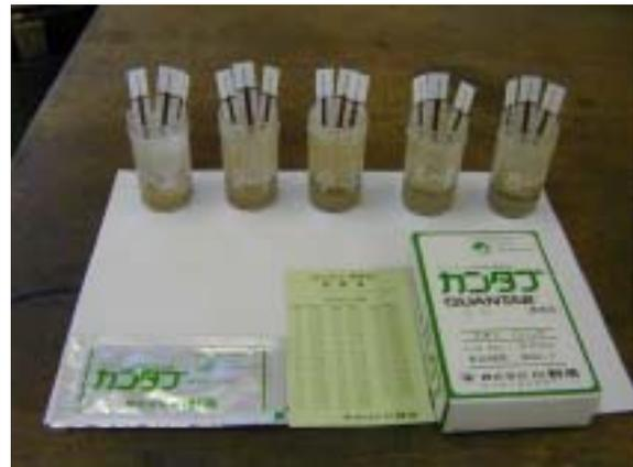
写真 - 3 塩分測定計ならびに測定状況
