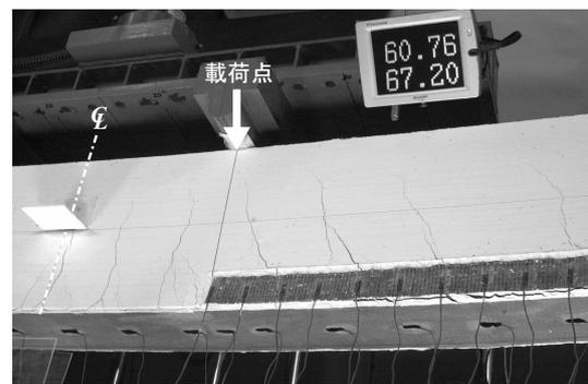
写真－1 剥離直前の側面補強シートの状況 (S40 試験体)
