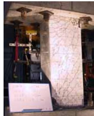
写真-1 (1) ひび割れ状況(試験体 RC)
