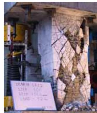
写真-1 (3) ひび割れ状況(試験体 SRC2)
