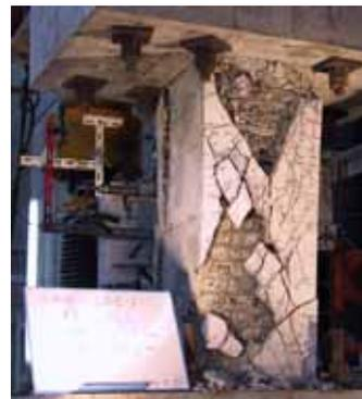
写真-1 (2) ひび割れ状況(試験体 SRC1)
