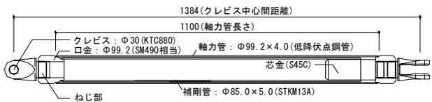
図-2 制振ブレース形状
