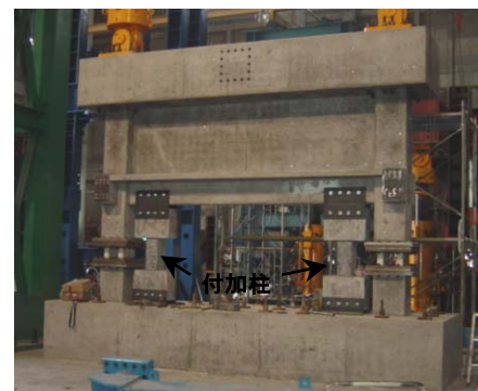
b) 付加柱設置後
