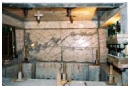
図 - 10 1階耐力壁の最終破壊性状(静的加力)
