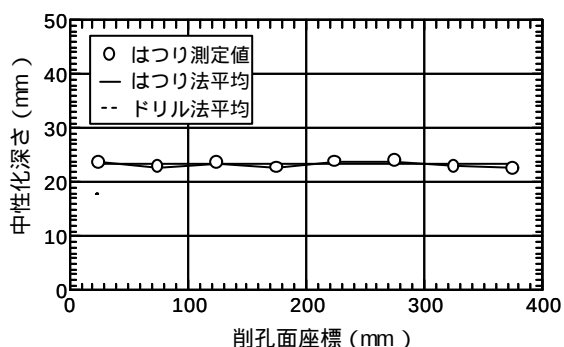
図 - 8 はつり法による中性化のばらつきとドリル法による測定値の関係
