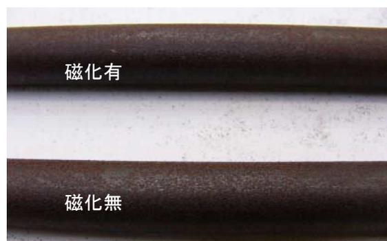
写真-3 磁化有，磁化無鋼棒の腐食試験結果
