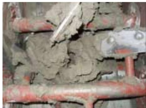
写真-5 強制2軸練りミキサ内での練混ぜの状態
