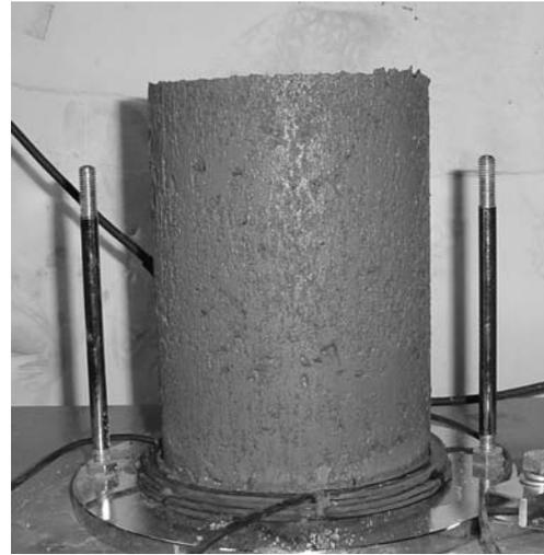
写真-1 コンクリートの締め固まり状況
