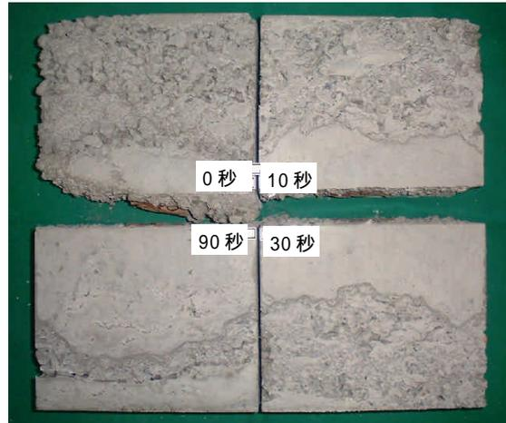
図-9 充填面積率の観察例(調合2-4, A面)
