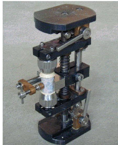
写真-2 キャッピング装置
