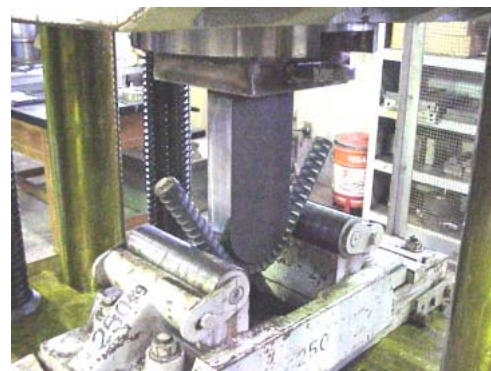
写真-3 曲げ試験の状況
