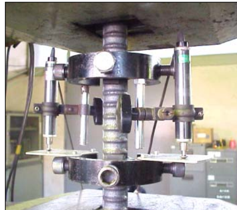
写真-2 予ひずみ付与および引張試験状況
