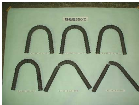
写真-8 予ひずみ付与後熱処理温度 550℃とした場合の曲げ試験後の供試体状況
