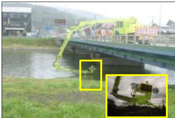
写真 - 2 モニターカメラ式橋梁点検車
