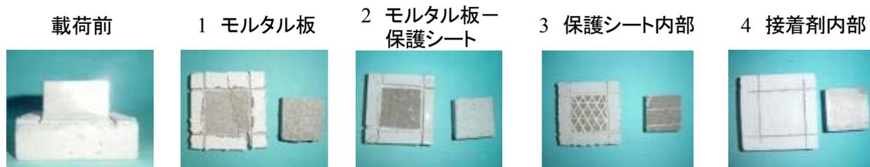
写真－3 破壊箇所一覧
