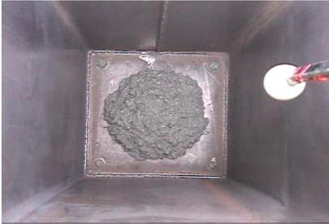
写真 - 1 試験体Aの打設状況（最上部）
