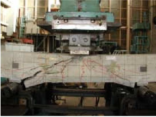
写真-1 静的試験体の破壊状況例 (SB)
