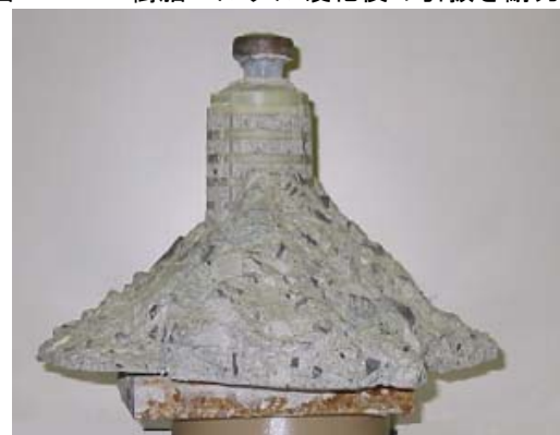
図-15 試験体 5-2-1 の破壊性状
