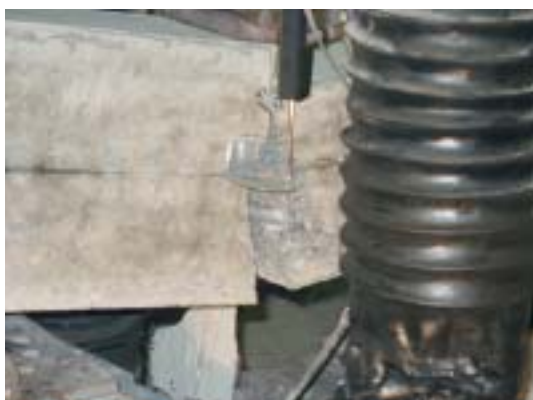
図-5 供試体の破壊性状の例 (一方向単調載荷試験, 曲げ卓越供試体, 直角)
