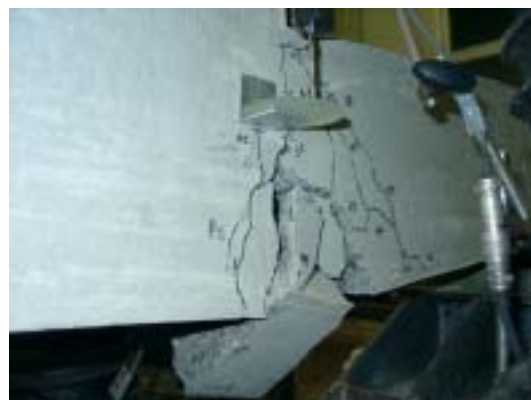
図-6 供試体の破壊性状の例 (一方向単調載荷試験, 曲げ卓越供試体, 柱 1:4)
