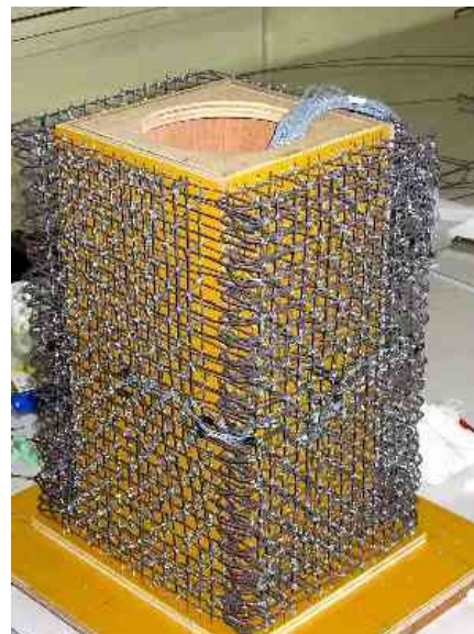
写真 - 1 配筋状況(ボックスガバート型試験体)
