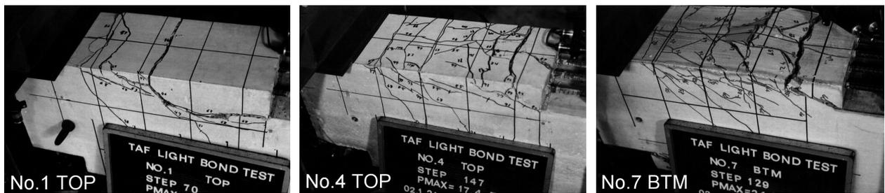
図-3 最終破壊状況
