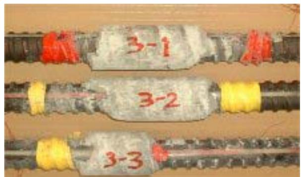
写真 - 2 実験 3 のグラウト付着状況
