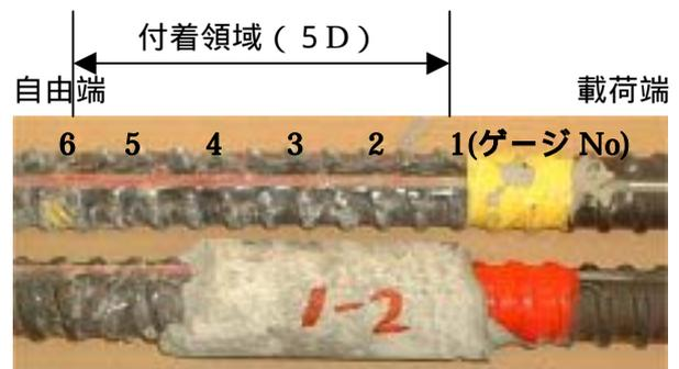
写真 - 1 実験 1-1 (上) と実験 1-2 (下) のグラウト付着状況
