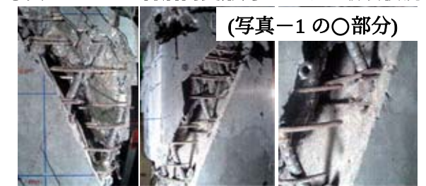
写真-2 せん断補強筋破断状況
