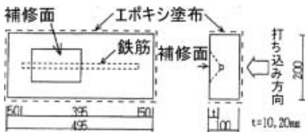
図 - 2 供試体および鉄筋
